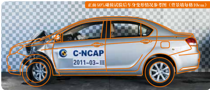
正面40%碰撞试验后车身变形情况参考图（背景墙每格10cm）
