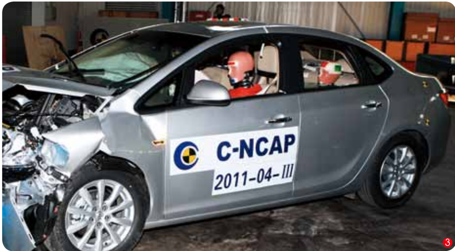
正面40%碰撞试验后车身变形情况参考图（背景墙每格10cm）
