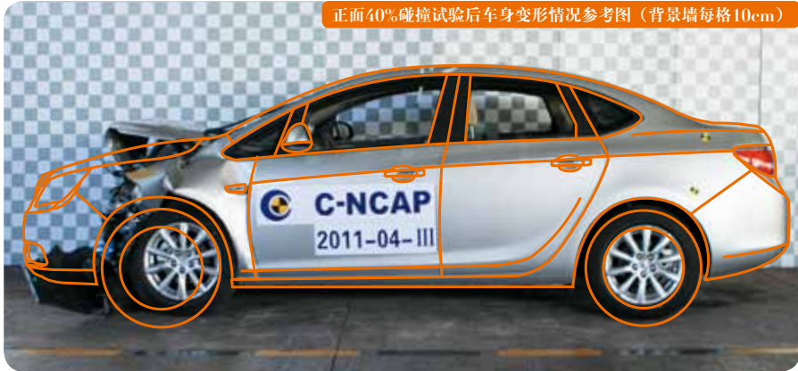
正面40%碰撞试验后车身变形情况参考图（背景墙每格10cm）
