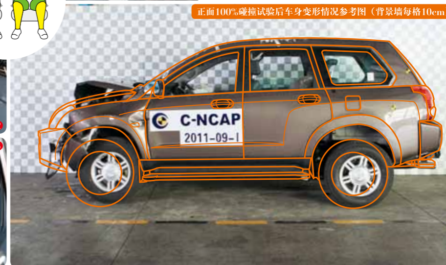
正面100%碰撞试验后车身变形情况参考图（背景墙每格10cm）
