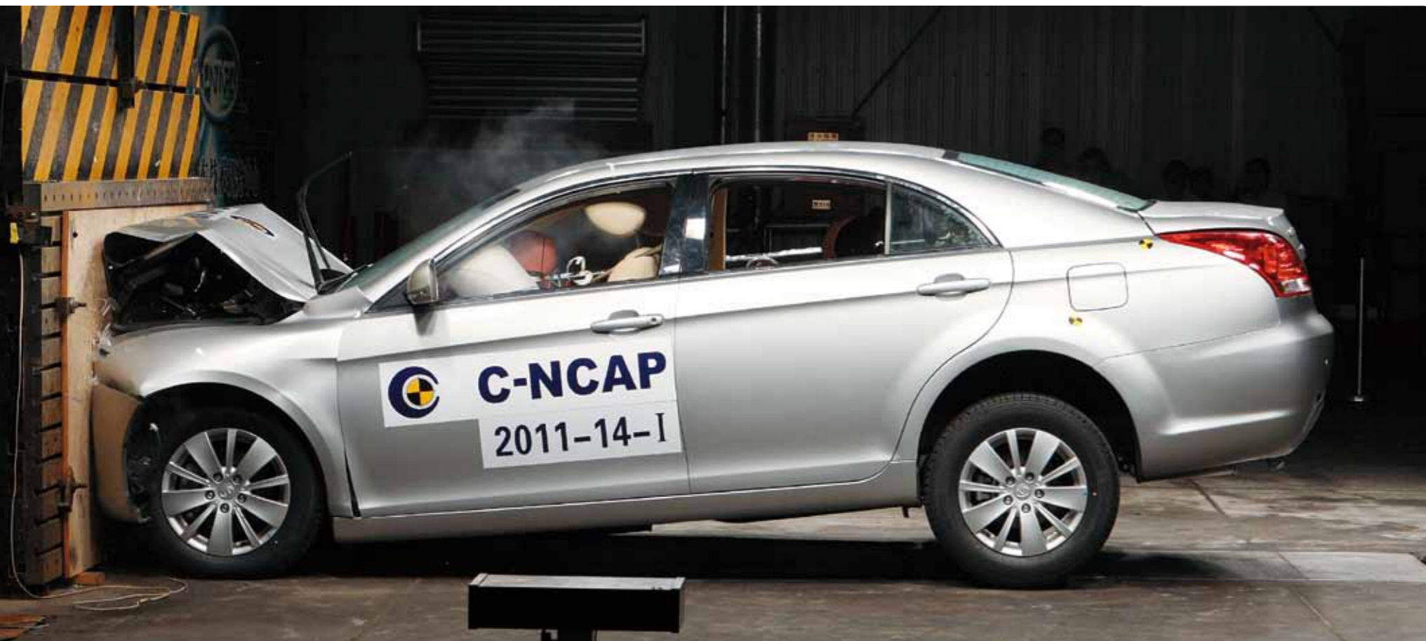
正面100%碰撞试验后车身变形情况参考图(背景墙每格10cm)
