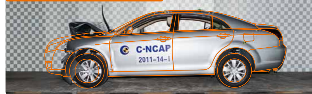
正面100%碰撞试验后车身变形情况参考图(背景墙每格10cm)
